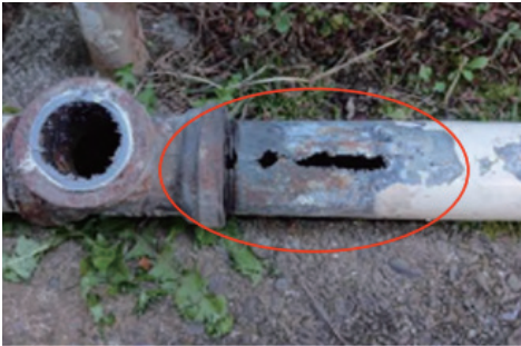
住戸内の排水管に穴が開き漏水が発生
