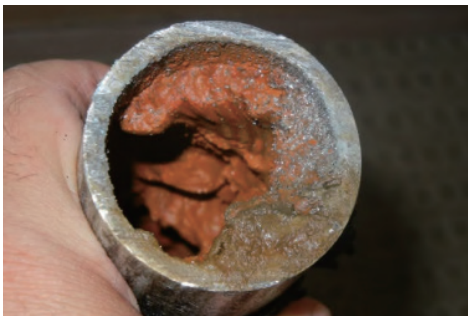
住戸内の排水管に穴が開き漏水が発生
