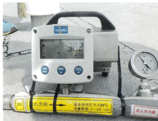
④ 流量計 圧力計 22L/分 15MPa
